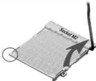
安装处理器的时候，请注意下图中的圆圈，此处的CPU脚座为半缺口的形状，请将处理器的脚针有缺口的一边和CPU脚座相对应。确定处理器是紧紧扣在CPU的脚座中，然后将拉杆放下紧紧扣在CPU脚座旁边的固定位置上。
