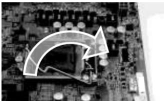
接着移除处理器插座上的黑色塑料保护盖，露出插座本体，注意此时千万不要用任何物体接触插座上的金属触片，以免导致插座损坏；
