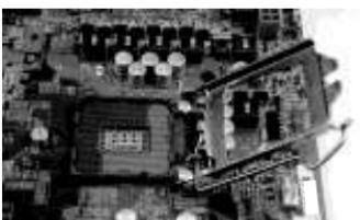
确定处理器边缘上的两个凹槽与插座上的两个凸点位置吻合，把处理器放入插座内，动作一定要轻盈柔，避免损伤插座触片。
