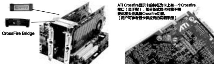
将桥接器（需用户购买）与两张显示卡上的CrossFire接头相连接；桥接器名为Native CrossFire Interface，是由两条CrossFire Bridge组成。以上步骤完成后，ATi CrossFire系统安装完毕。
