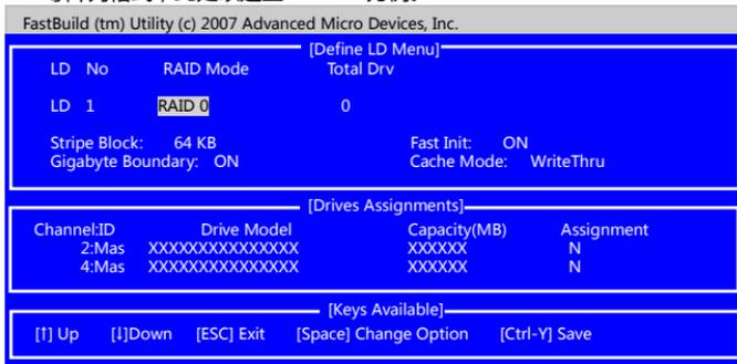
将光标键移到“Assignment”项，按空格键把要构成 RAID 的硬盘由默认的“N”更改为“Y”，此时“Total Drv”项的数字也会随硬盘的数目发生相应变化。然后连接两次“Ctrl-Y”进行保存，待出现下图容量设定提示时可设置把多少硬盘空间用于 RAID 的组建：
