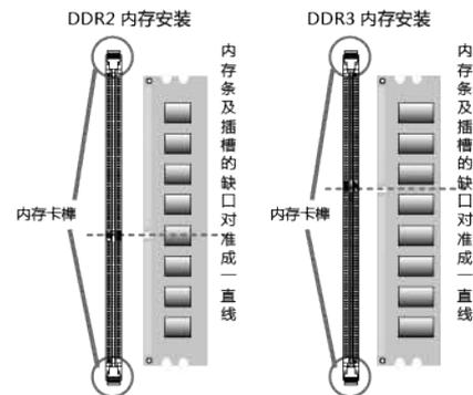
中即可工作在双通道模式下。由于5/6系列芯片特殊性，因此在安装内存时，必须要优先把内存安装在DDR3\_A2或A4插槽上，只有在这两个插槽插满内存之后，其他颜色的插槽才能正常使用。
