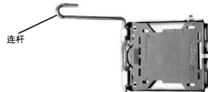
接着移除处理器上的塑胶盖，拉起金属上盖；
