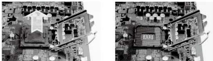
确定处理器边缘上的两个凹槽与插座上的两个凸点位置吻合，把处理器放入插座内，动作一定要轻柔柔和，避免损伤插座触点。
