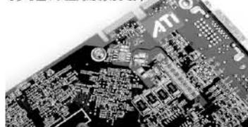
将桥接器（需用户购买）与两张显示卡上的CrossFire接头相连接；桥接器名为Native CrossFire Interface，是由两条CrossFire Bridge组成。以上步骤完成后，ATI CrossFire系统安装完毕。
