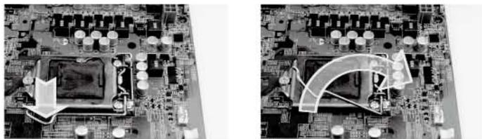
接着移除处理器插座上的黑色塑料保护盖，露出插座本体，注意此时千万不要用任何物体接触插座上的金属触点，以免导致插座损坏；
